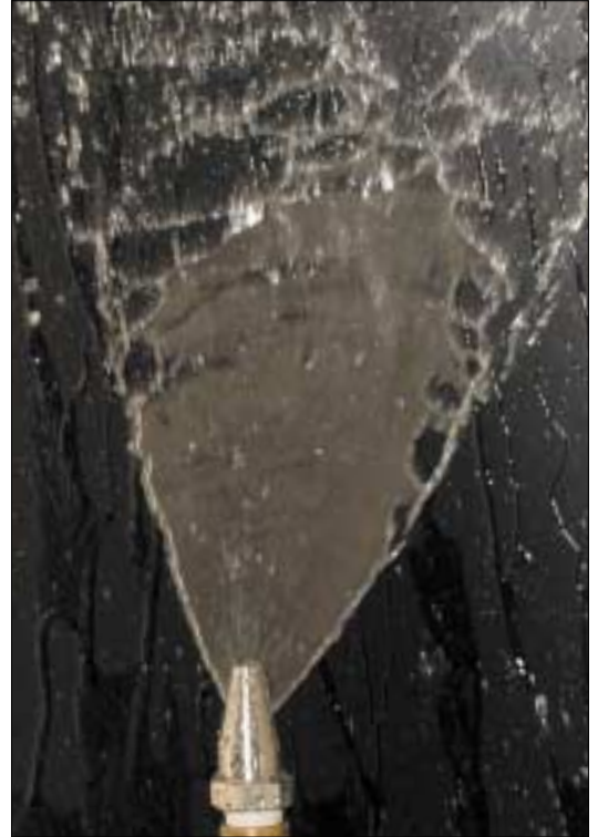
Tipo / Type OLP pressione/pressure 0,3 BAR
